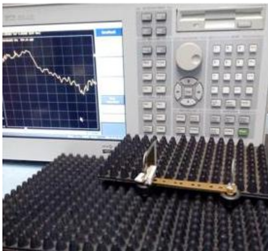
Измерительный стенд с измерительными антеннами магнитного типа и закреплённым исследуемым экраном с размерами сторон 30x30.
